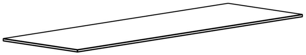
Aussenkanten umlaufend gesäumt und geschliffen
