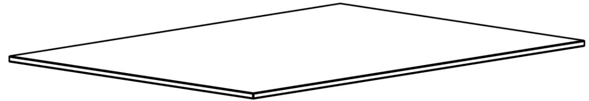
Aussenkanten umlaufend gesäumt und geschliffen
